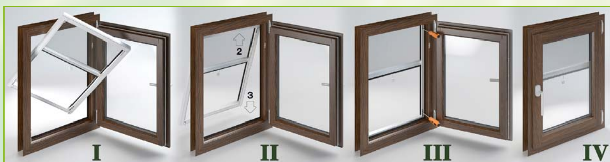
I. Inserire il telaio attraverso il serramento - II. Innestare le staffe a "Z" più lunghe in alto, poi quelle in basso - III. Fissare le staffe. - IV. FATTO!
